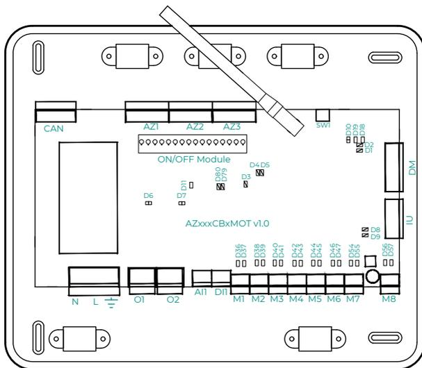
**Importante:** Se si dispone di un sistema Easyzone EZ8, è possibile integrare un modulo di controllo On/Off di zona al pannello della scheda centrale (AZCE6ACCOFF).
