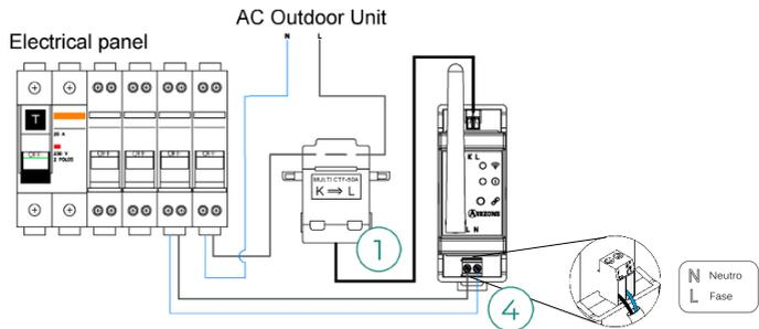
Il collegamento per l'alimentazione elettrica al modulo ④ avviene mediante un morsetto a 2 pin. Fissare i cavi con le viti del morsetto rispettando la sua polarità.
