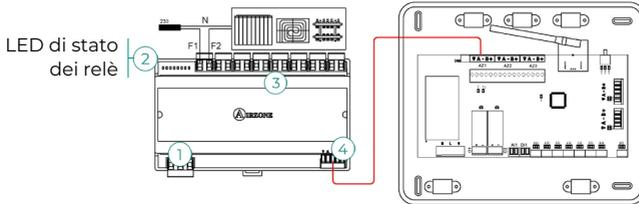
Le caratteristiche dei relè di controllo ③ sono I<sub>max</sub> da 10 A a 110/230 VAC senza alimentazione. Per controllare elementi di potenza maggiore, si consiglia l'uso di contattori della potenza da controllare. Si prega di ricordare di collegare direttamente il neutro dal circuito fino all'elemento da controllare.
