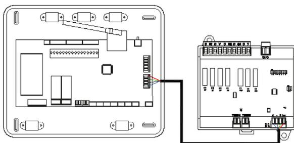
Le caratteristiche dei relè di controllo sono ① ② ③ ④ ⑤ 24/48 VAC senza alimentazione. Per controllare elementi di potenza maggiore, si consiglia l'uso di contattori della potenza da controllare.
